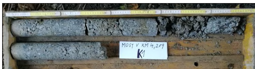
Obr. č. 3 - diagnostický vrt K1 do klenby
