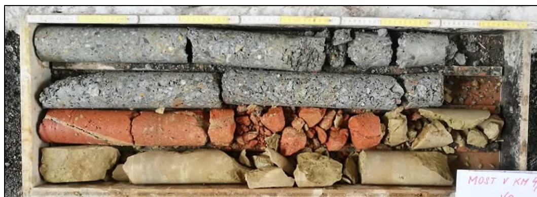
Obr. č. 5 - diagnostický vrt V2 do opěry Česká Třebová
