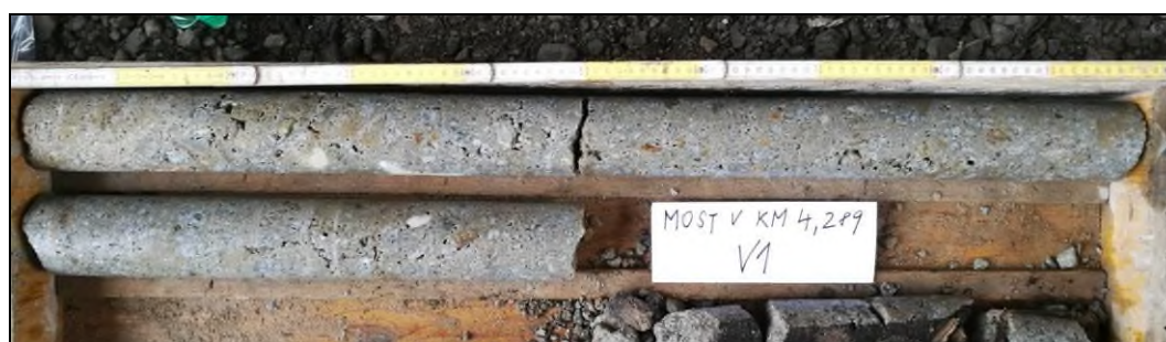
Obr. č. 2 - diagnostický vrt V1 - pilíř
