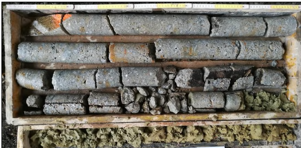
Obr. č. 1 - diagnostický vrt Š1 - pilíř
