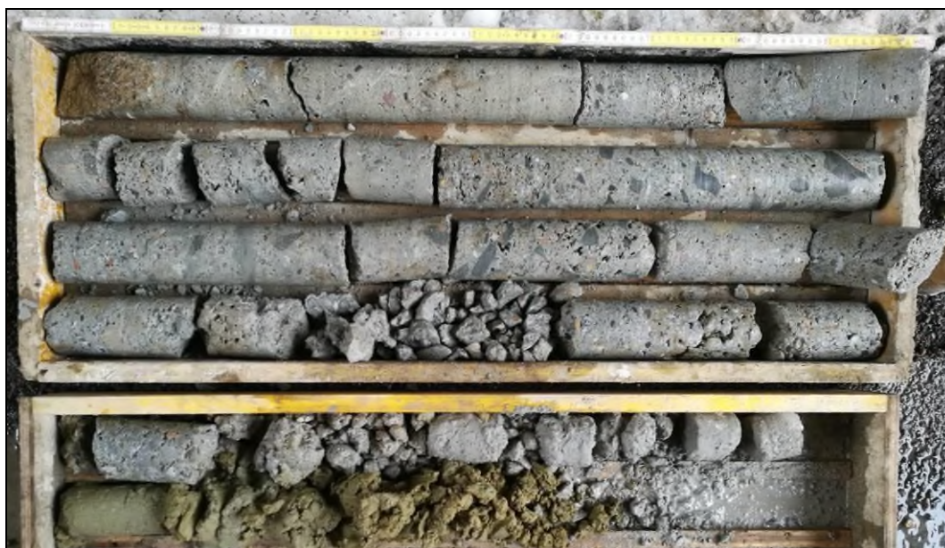
Obr. č. 4 - diagnostický vrt Š2 do opěry Česká Třebová
